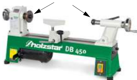
Fig.6: Desengrasar los soportes cónicos
